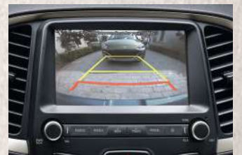
Cámara de retroceso
